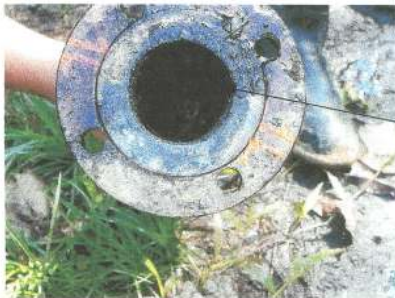
Fig. 16 Tubo testigo Limpio del pozo Lisama 54 en el que se aprecia un incremento en el grado de deposición de parafina.
