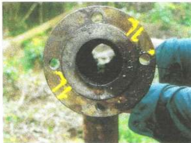
Fig.-15 Tubo testigo limpio después de más de cinco meses de prueba, no se observa Parafina ni grumos.
