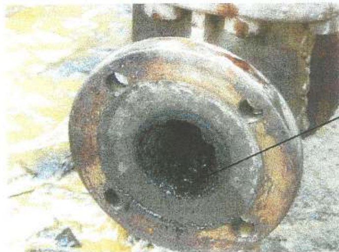
Fig. 35 en la cual se observa la válvula numero 2 Luego de la revisión de los testigos procedimos a revisar el estado de las celdas en la carcasa instalada en el plano del pozo y se encontró que las celdas sólo presentaban grumos de parafina y en algunas celdas algunas manchas que eran el reflejo de la acción del campo diamagnético con el fluido del pozo.
